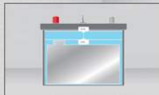
Nieuw design met lager geplaatste platen voor een grotere vloeistofinhoud
